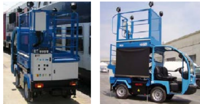
SNCF Paris Nord Plate-forme élévatrice mobile 350kg sur camionnette électrique SNCF Paris Nord: Mobile lifting platform 350Kg on electrovan
