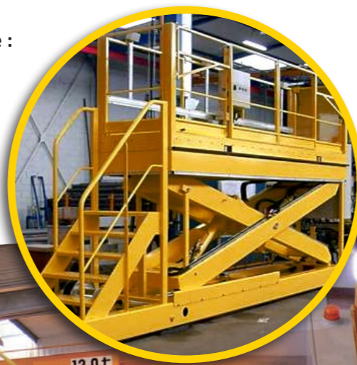
SNCF Paris Nord Plate-forme élévatrice mobile 350kg sur camionnette électrique SNCF Paris Nord: Mobile lifting platform 350Kg on electrovan
